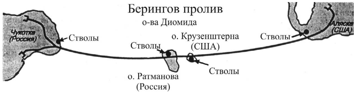
Рис. 4.1. План трассы железнодорожного тоннеля под Беринговым проливом
