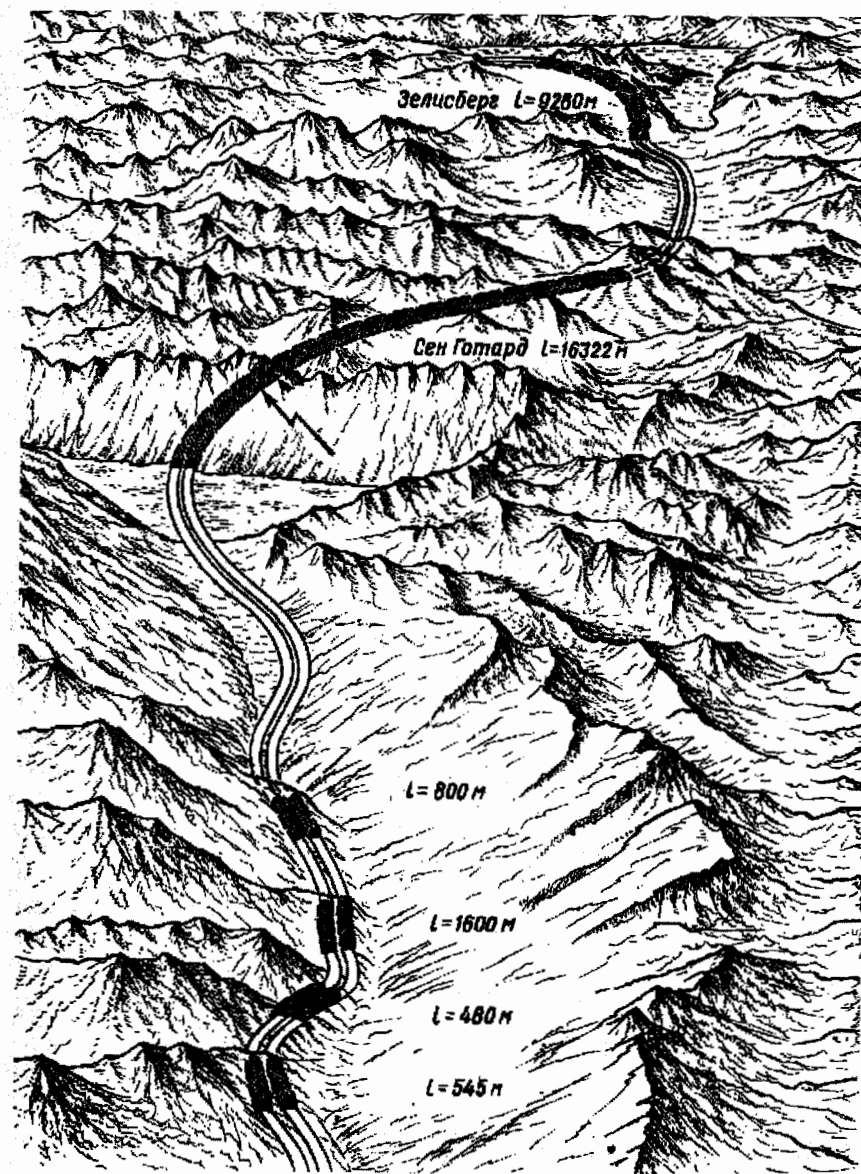
Рис. 1.5. Схема расположения железнодорожных тоннелей в Швейцарских Альпах
